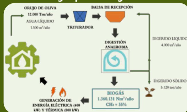
Producción de biogás para autogeneración de energía
